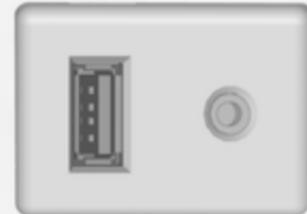
На центральной консоли имеется гнездо USB для подключения внешних источников аудиосигнала.
