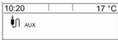
Источником звукового сигнала, подключенным ко входу AUX, можно управлять только с помощью органов управления этого источника.
